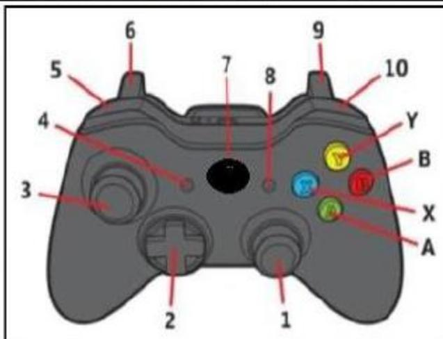
**Direction :** Pour diriger le véhicule, orientez progressivement le joystick de direction (1) à gauche (resp. à droite) pour tourner à gauche (resp. à droite) dans le sens d'avancement.
