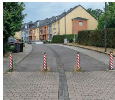
Impasse franchissable aménagée avec des bornes fixes
