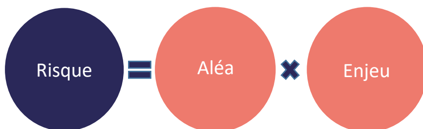
Figure 2 : Equation du risque : le risque est le résultat de la combinaison de l'aléa et d'un enjeu (en fonction de sa vulnérabilité et de son exposition).
